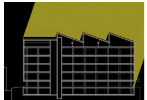
Fig. 5 - Sezione longitudinale e collegamento durante l'estate: inclinazione raggi solari 71°
